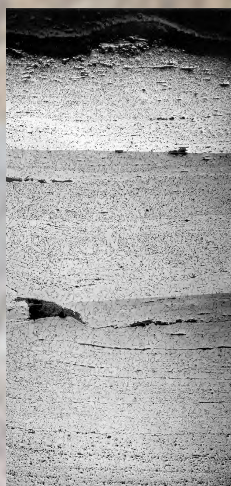
Metalografický nábrus sekery, ktorá bola skúvaná z ocelových plátov za tepla. Svedčia o tom oxidické nečistoty medzi plátmi a skokové zmeny v štruktúre. Foto P. Brziak
